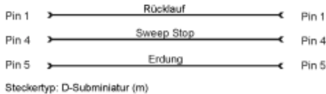
Abbildung 2-7 Pin-Konfiguration des RS-232-Kabels
